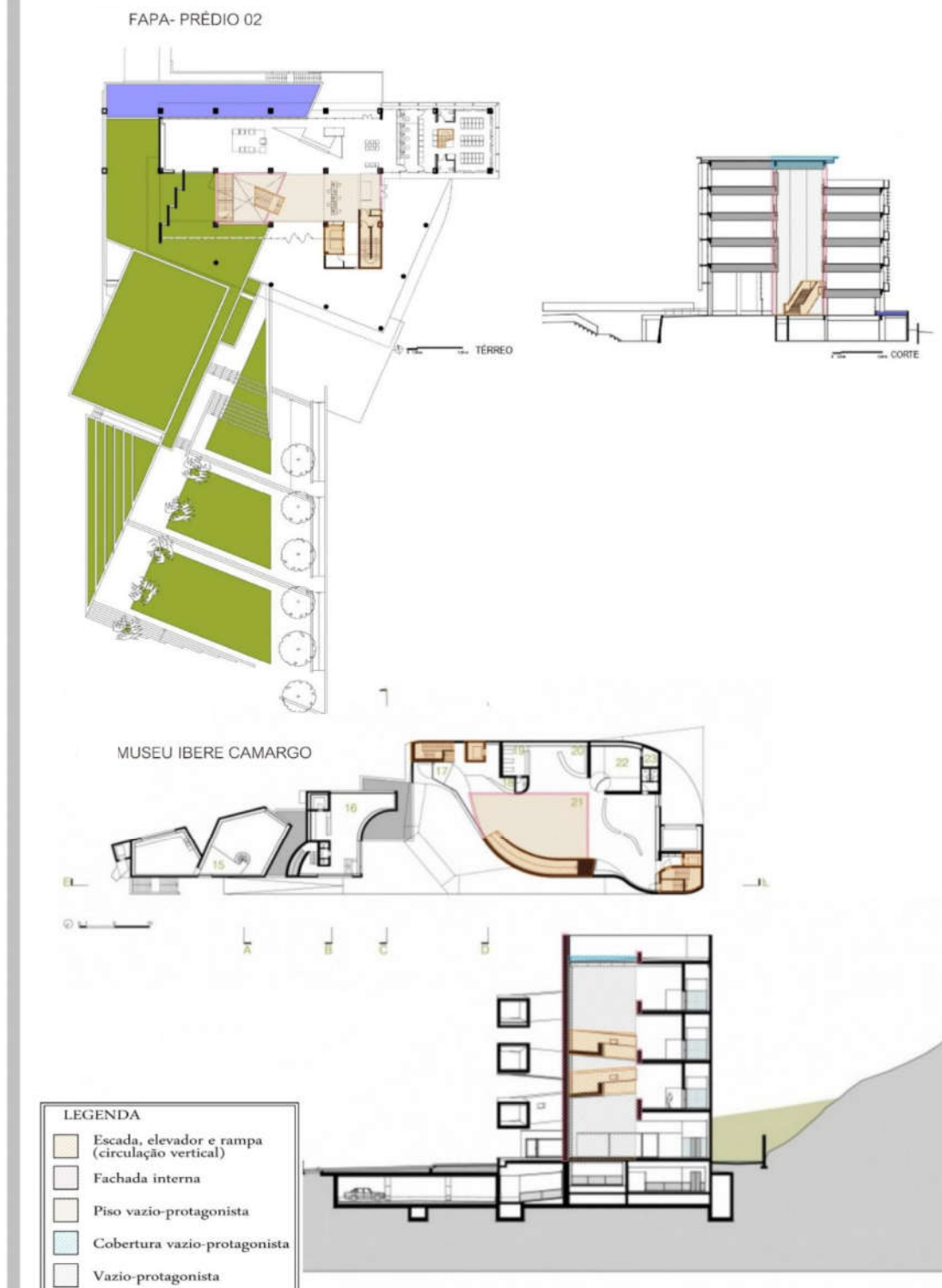
Figura 147 - Marcação das partes que compõe o vazio hachurados em redesenho das plantas baixas do Prédio 02 da FAPA (2007) e Museu Iberê Camargo (2008).
