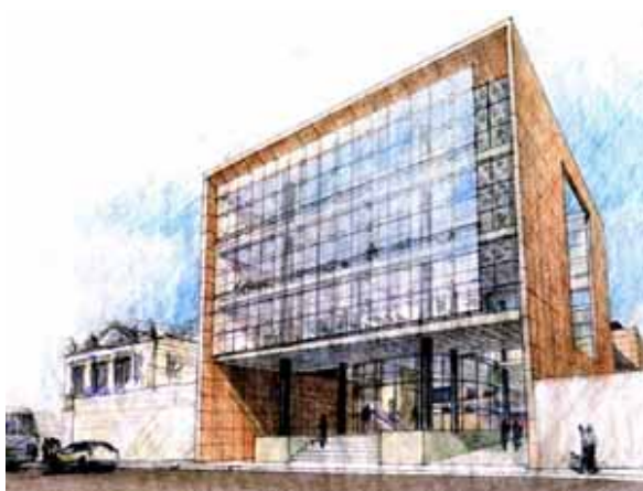
Figura 14 - A perspectiva da fachada principal mostra o grande pórtico revestido em arenito, tendo o vão central preenchido pela duplicação de planos de vidro. O térreo em pilotis, transparente e permeável dá acesso ao bloco posterior.
