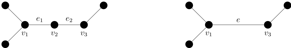
Figura 3.2: Duas arestas em série podem ser substituídas por uma única aresta, cuja resistência é a soma das resistências das arestas originais.
