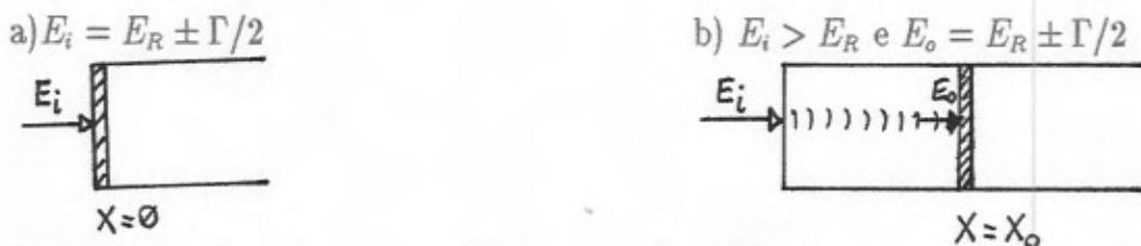
**Figura 26** - Desenho esquemático da camada analisada ressonantemente : (a) quando a energia de incidência é próxima à energia de ressonância ; (b) quando a energia de incidência é maior que a energia de ressonância.
