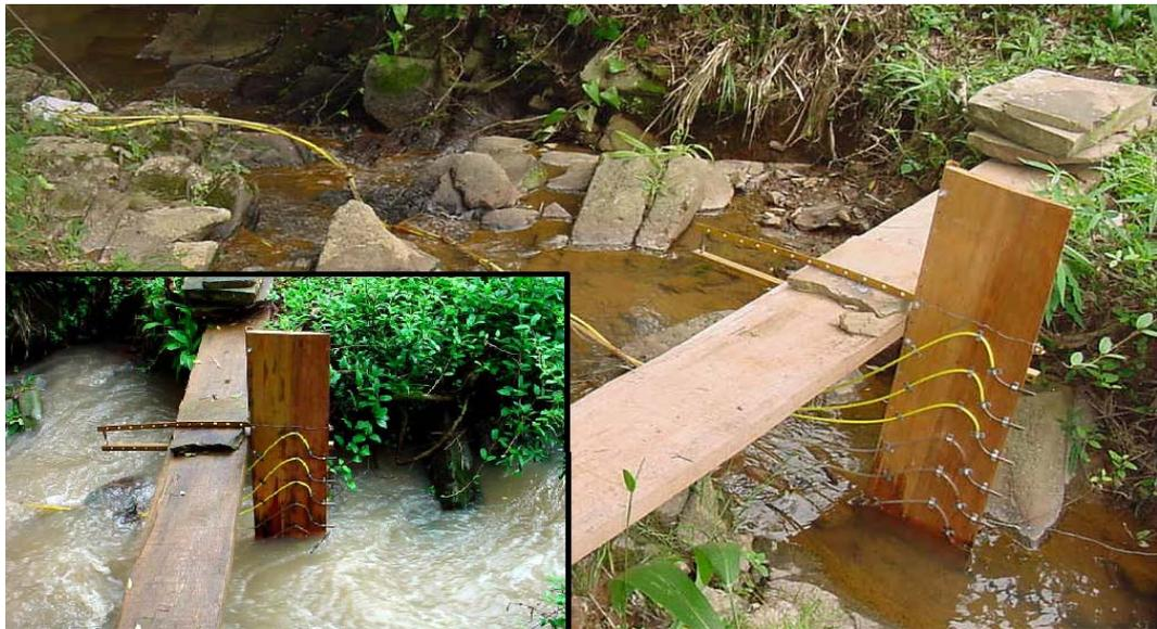
Figura 5.4. Foto do amostrador utilizado para a coleta de sedimentos em suspensão.
