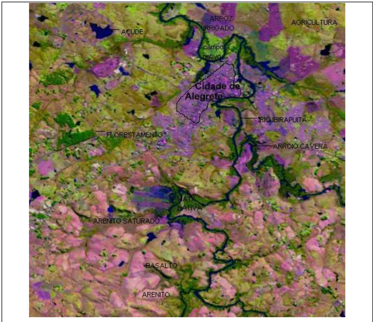
Figura 3.1 – Composição colorida de Imagens de Satélite do Sistema LANDSAT 5 TM, bandas 3B, 4G e 5R, com identificação de feições que caracterizam a heterogeneidade da superfície terrestre.
