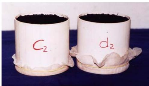
**Figura 2.** Cilindros de Policloreto de Vinila - PVC - com volume interno de 750 ml, forrados com tecido de nylon preso por um atilho de borracha, utilizados para obtenção da curva de retenção de água na Mesa e no Funil de Tensão. Faculdade de Agronomia - UFRGS, Porto Alegre, 2003.
