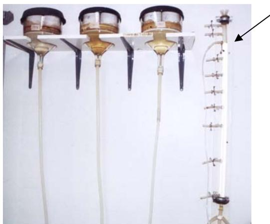
**Figura 4.** Conjunto de Funis de Tensão (com capacidade individual para três cilindros de PVC com 750 ml cada) utilizado para obtenção da curva de retenção de água, ajustado para sucção a 10 hPa. Faculdade de Agronomia - UFRGS, Porto Alegre, 2003.
