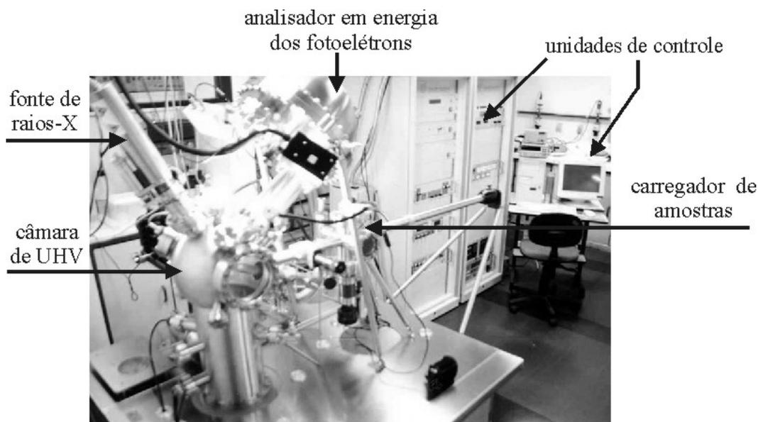
*Figura 44: Foto do equipamento de XPS existente no Laboratório de Superfícies e Interfaces da UFRGS.*
