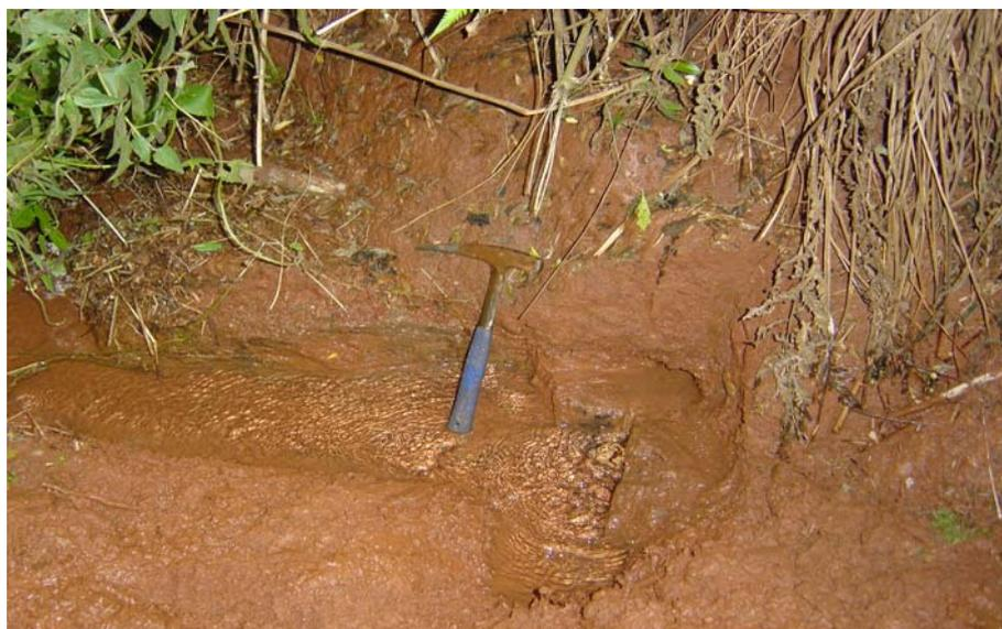
Figura 5.9 – Surgência de água em fratura com direção N 20 W, voçoroca nº 60
