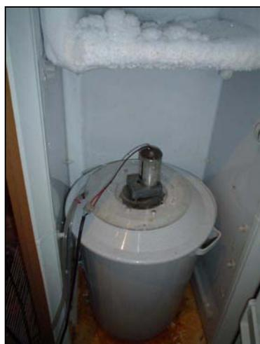
Figura 4.5 – Geladeira usada para armazenar esgoto com DQO ajustada para 300 mg/L
