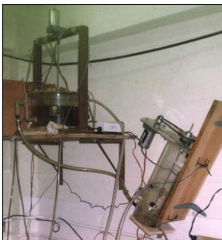
Figura 4.2 – Sistema de lodos ativados com fluxo contínuo para remoção de matéria orgânica
