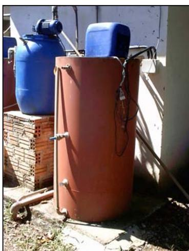
Figura 4.8 - Sistema de lodos ativados em batelada na escala piloto
