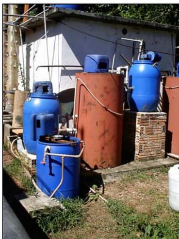
Figura 4.7 - Sistema de lodos ativados com fluxo contínuo em escala piloto.
