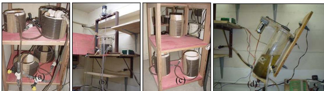
Figura 4.3 – Sistema de lodos ativados Bardenpho: (a) reator de pré-desnitrificação, (b) reator aeróbio, (c) reator de pós-desnitrificação e (d) decantador secundário.
