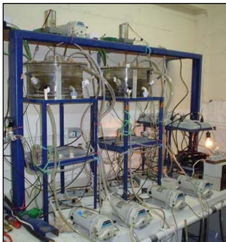
Figura 4.1 – Reatores seqüenciais em batelada em escala de bancada
