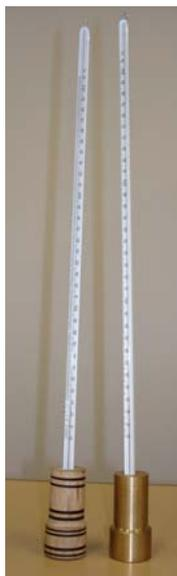
**Figura 5.2:** Blocos utilizados na atividade sobre equilíbrio térmico.
