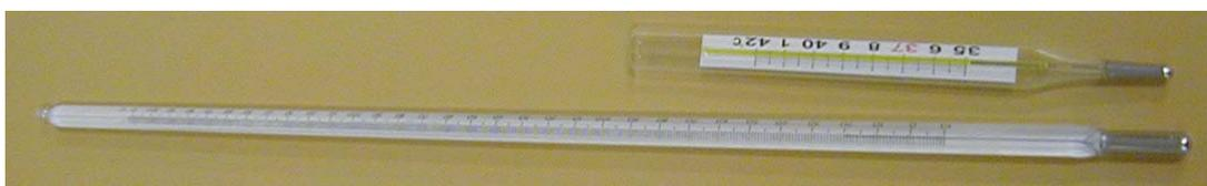
**Figura 2: Termômetro clínico (acima) e termômetro de laboratório (abaixo).**
