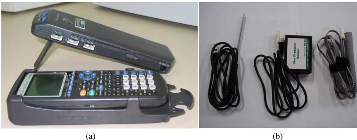
**Figura 4.3:** Sistema CBL. Em (a) temos a calculadora gráfica e o dispositivo de coleta automática de dados, e em (b) alguns sensores como o de temperatura, o de pressão em gases e o de intensidade luminosa (mostrados da esquerda para a direita).
