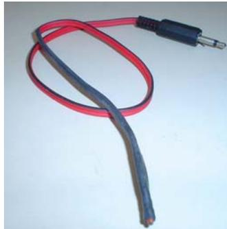
Fig. 20 - NTC ligado a um *plug* tipo P2.
