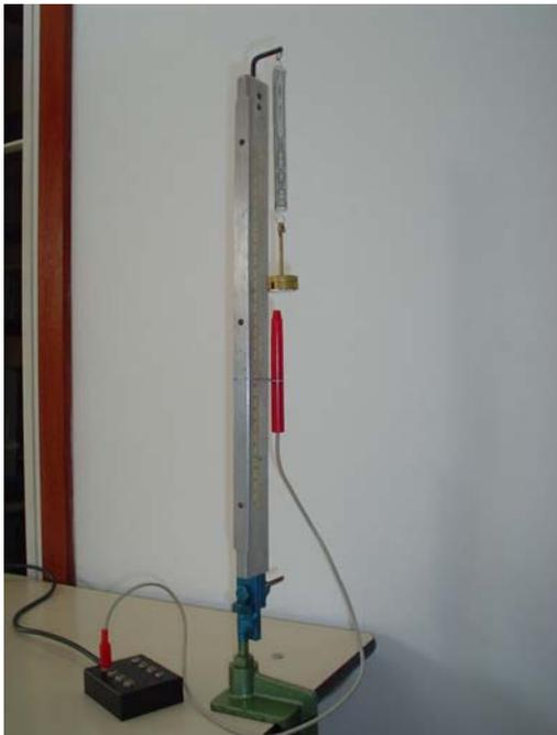
Fig. 19 - Sistema massa- mola com sensor LDR
