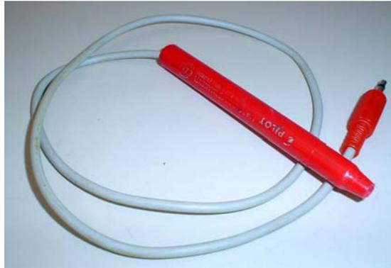
Fig. 32 - LDR com cabos disposto no interior de uma caneta.
