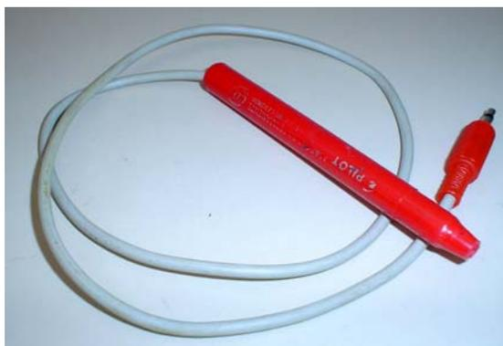
Fig. 17 - LDR com cabos disposto no interior de uma caneta.
