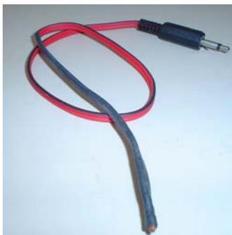
Fig. 36 - NTC ligado a um plug tipo P2.
