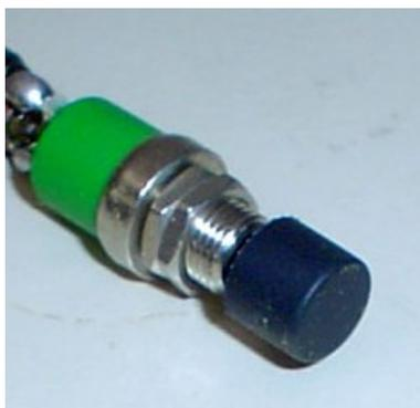
Fig. 24 - Chave liga-desliga tipo push button.
