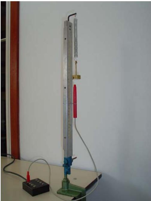
Fig. 34 - Sistema massa- mola com sensor LDR
