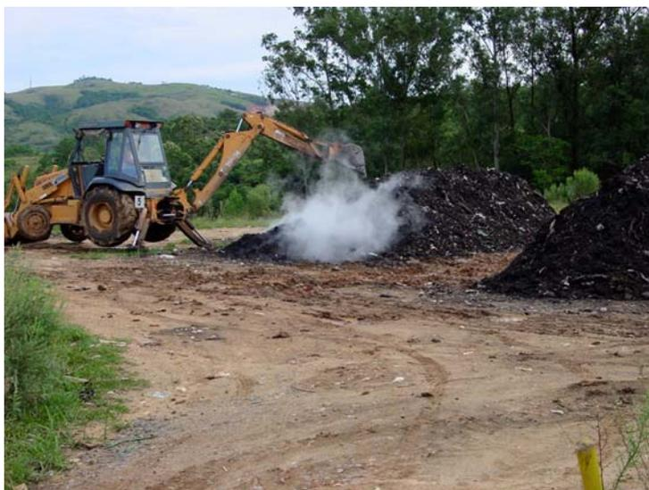
Figura 3.9 - Retroescavadeira utilizada para revolvimento de leiras de compostagem
