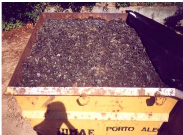
Figura 5.10 – Fotografia do lodo seco utilizado na Etapa 1
