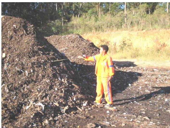
Figura 4.24- Medição de temperatura nas leiras
