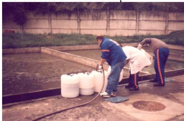
Figura 5.11 – Fotografia da coleta de lodo sedimentado do tanque de aeração (etapa 3)
