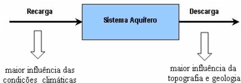
**Figura 2.3: Balanço hídrico simplificado em um aquífero em equilíbrio dinâmico**
