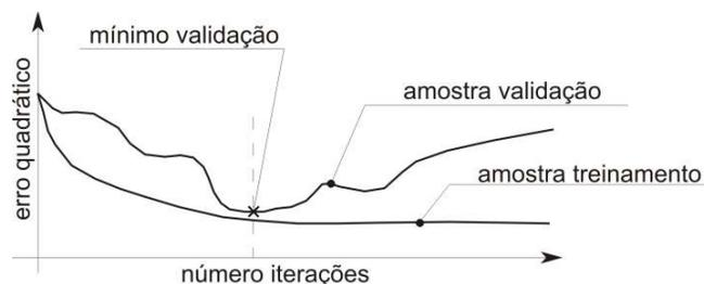
Figura 2.11 - Função do Erro Quadrático da amostra de Treinamento e de Validação.
