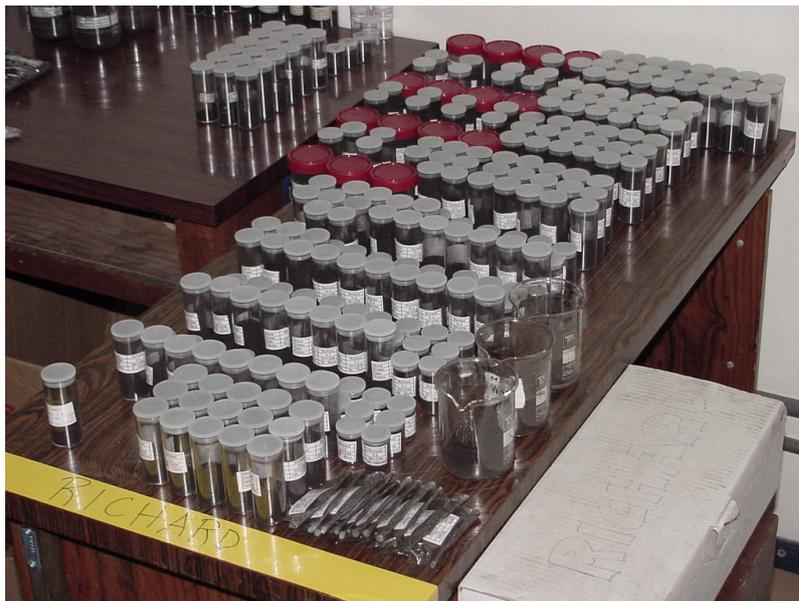
Figura 5.11 Amostras acondicionadas em potes plásticos para análise granulométrica
