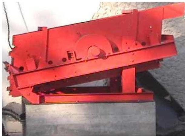
Figura 5.6 Peneirador Tyson de intensidade variável
