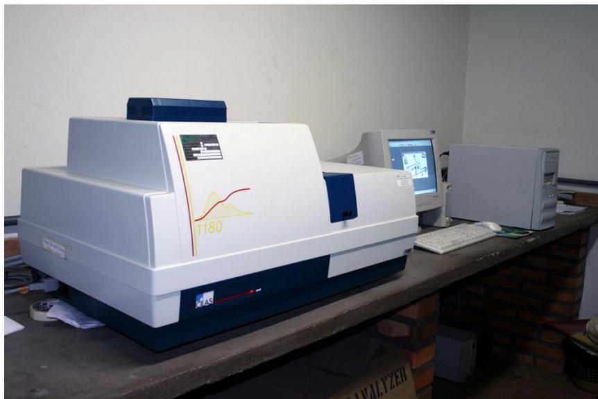
Figura 5.5 Analisador de partículas a laser
