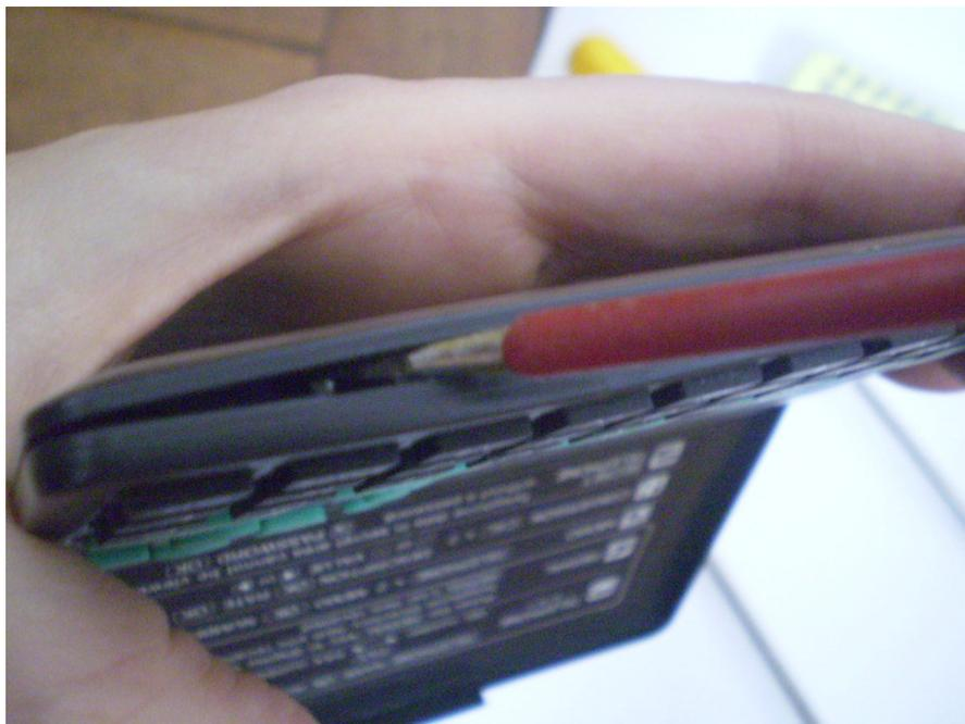
**Figura 22: chave de fenda inserida entre as partes da agenda**
