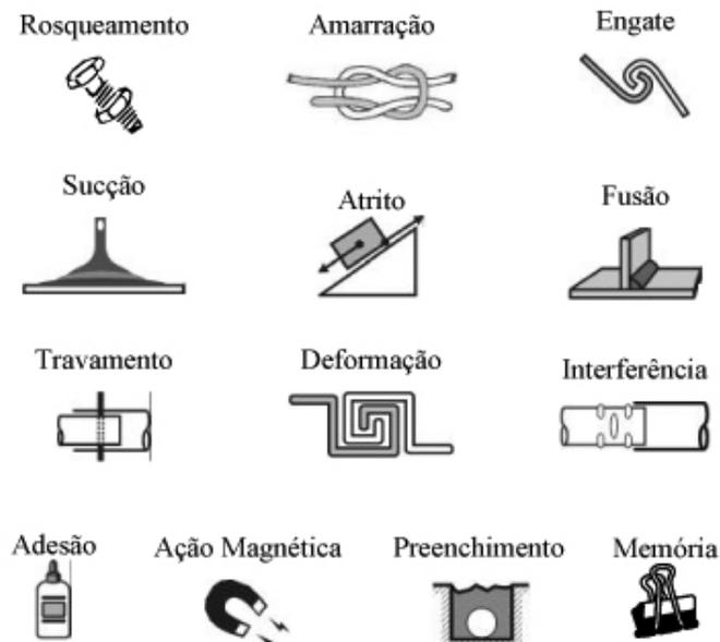
**Figura 26: Elementos de junção**
