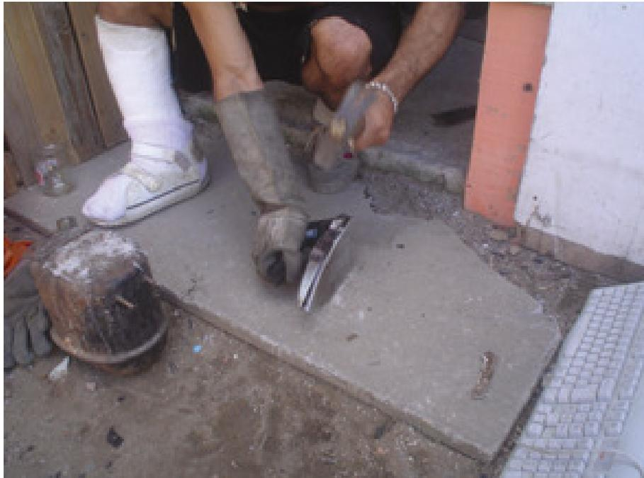
**Figura 19: Uso de martelo para quebrar o ferro de passar.**
