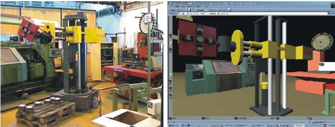
Figura 18: Célula real de fabricação de peças e o modelo em realidade virtual.
