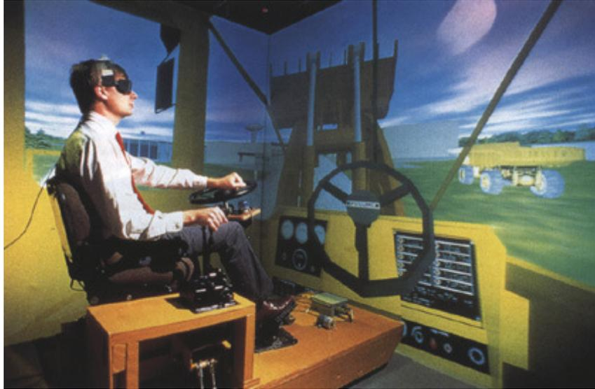
Figura 16: Simulador em Realidade Virtual de uma Carregadeira *Caterpillar*.
