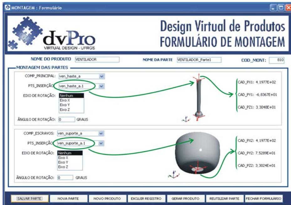
Figura 100: Formulário de montagem da “parte 1” do ventilador.
