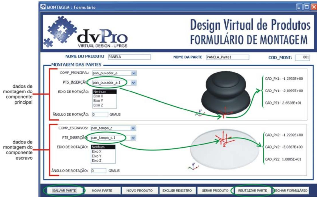
Figura 84: Formulário de montagem com os componentes da “PANELA\_Parte1”.
