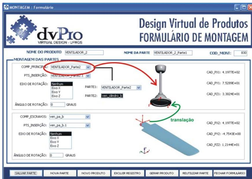
Figura 108: Formulário de montagem com reutilização de partes do ventilador.
