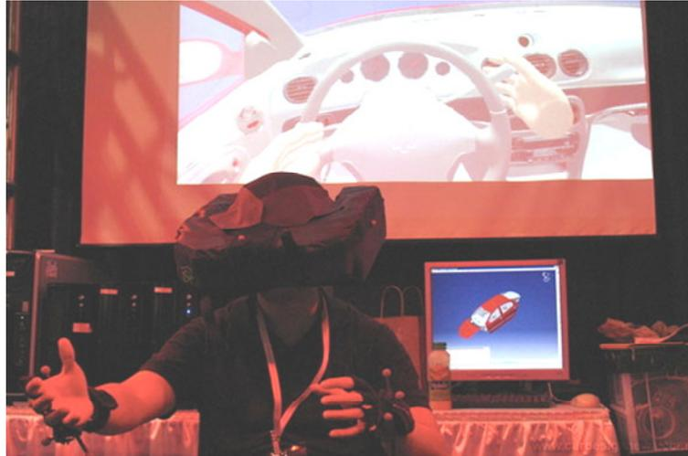
Figura 84: Imersão no interior de um veículo através do sistema de realidade virtual da *GM Virtual Eye*.
