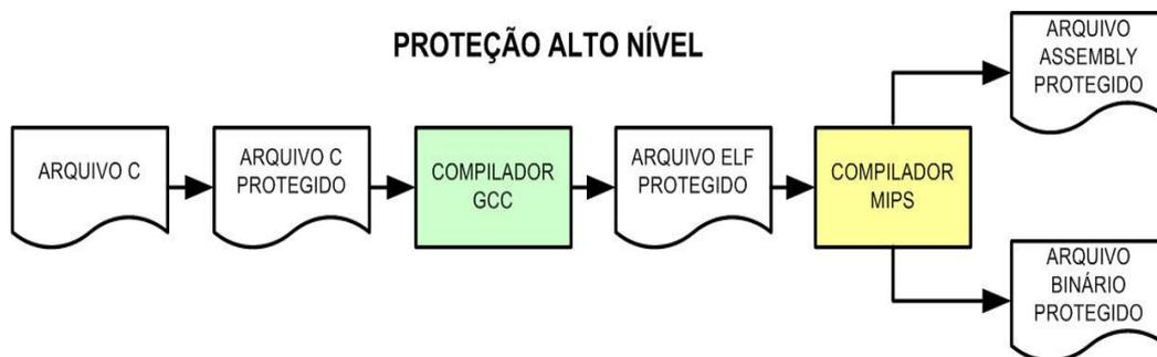
Figura 7.1: Proteção no nível C.
