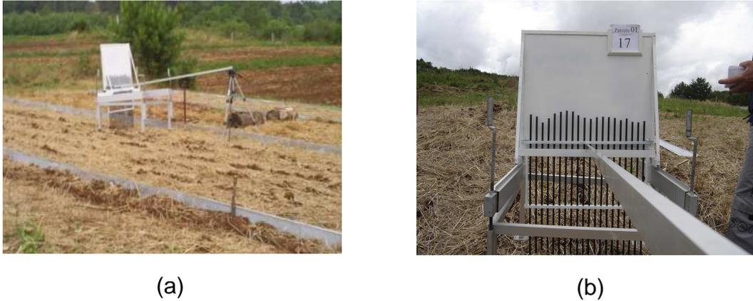
FIGURA 4. Vista do rugosímetro ou perfilômetro utilizado na medição da rugosidade superficial do solo (a), em operação sobre uma unidade experimental do estudo (b).
