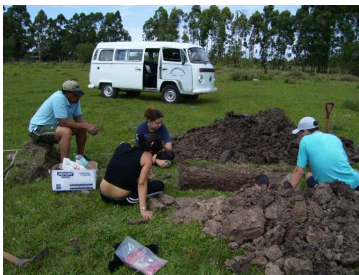
Foto 5: Trincheira aberta do P4 por ocasião da descrição morfológica e coleta de solo.
