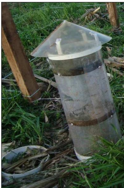
**Figura 3.** Foto ilustrativa do coletor de PVC utilizado nos estudos de volatilização de amônia.
