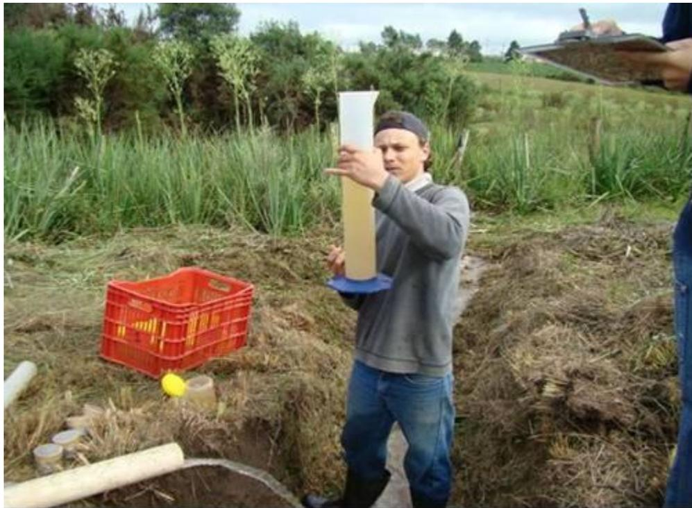
Figura 7: Medição do volume coletado no tempo para o cálculo da vazão (Gebler, 2010).
