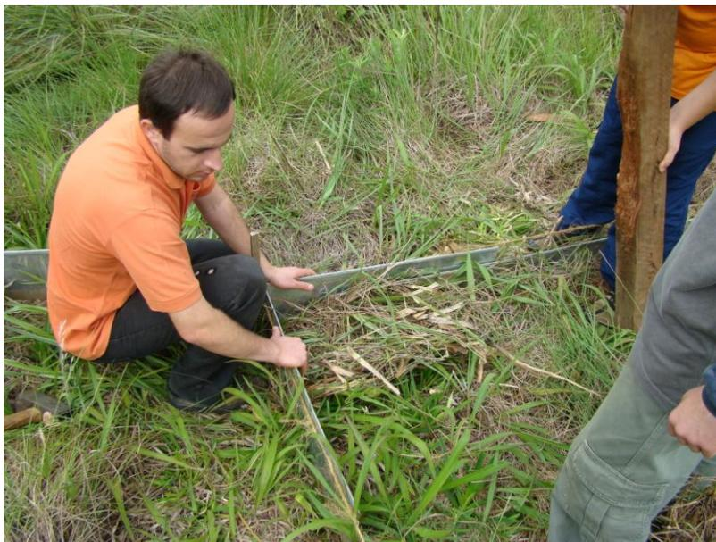
Figura 11: Posicionamento da chapa de canto superior.
