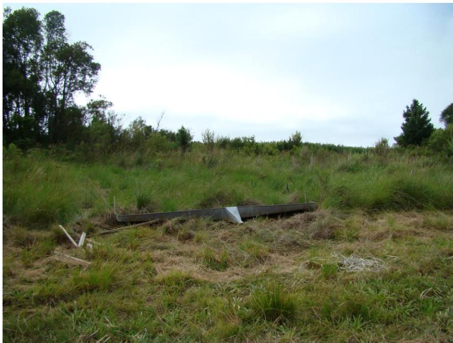
Figura 4: Posicionar o coletor na parte inferior da parcela.
