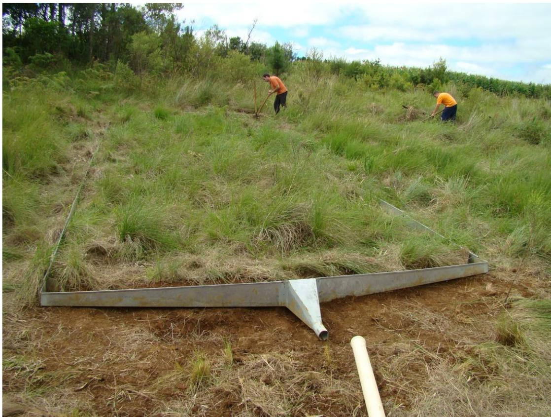
Figura 13: Visão da parcela experimental de 38,5 m<sup>2</sup> pronta.
