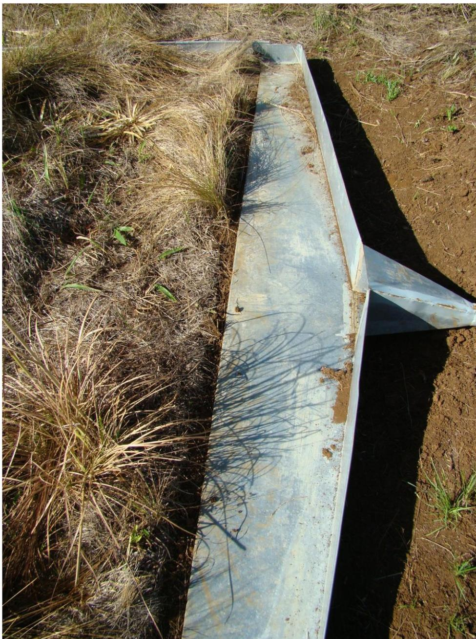
Figura 17: Detalhe do coletor de água da parcela, lembrando que antes da chuva simulada deve ser feita a limpeza do solo ali presente.
