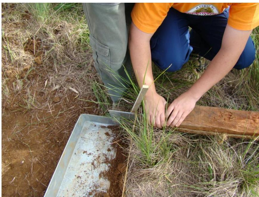
Figura 8: Cuidar para manter o alinhamento entre as estacas e a sobreposição com a chapa anterior.
