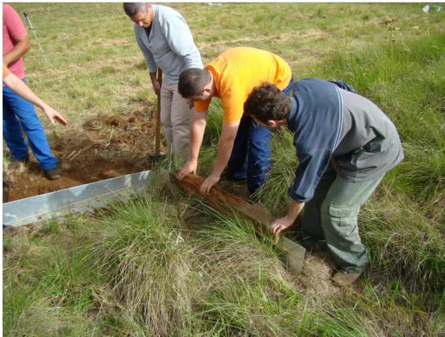
Figura 7: Instalação das paredes da parcela.
