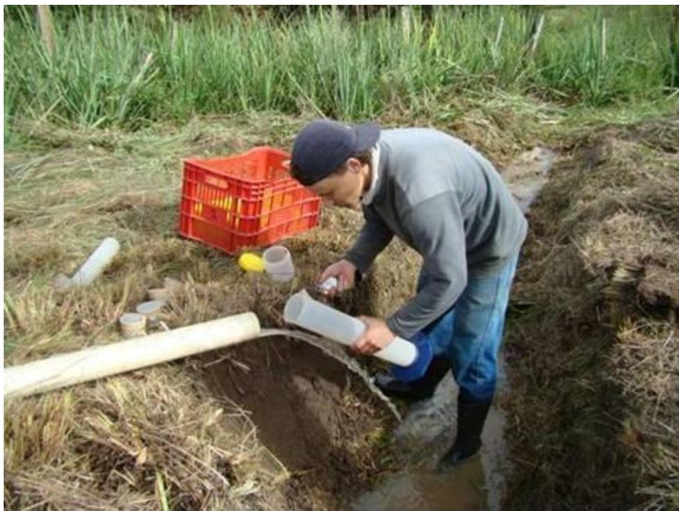
Figura 6: Coleta da enxurrada e tomada de tempo (Gebler, 2010).
