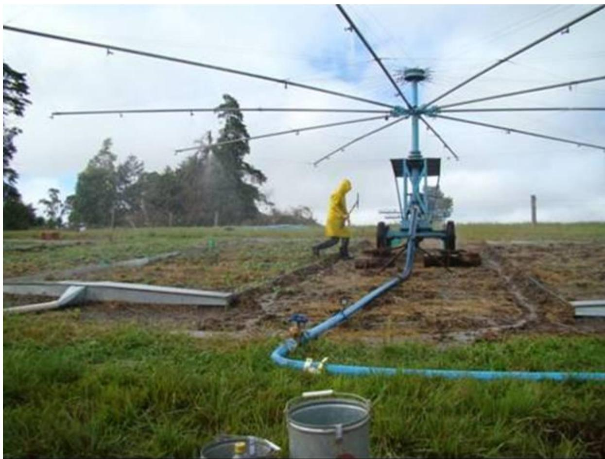
Figura 5: Vista da parte inferior das parcelas com a posição do simulador de chuvas (Gebler, 2010)
