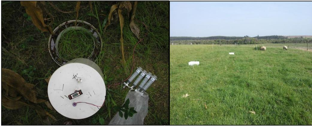
Figura 11. Câmaras utilizadas para a coleta de gases.
