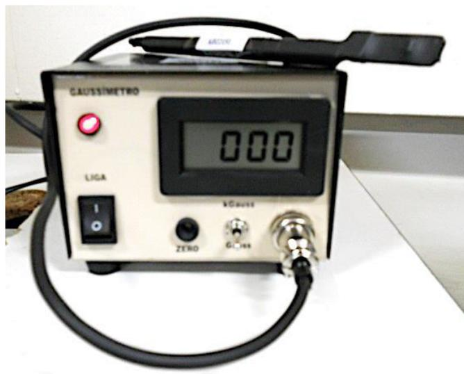
**Figura 4.9:** Gaussímetro construído para a execução deste trabalho.
