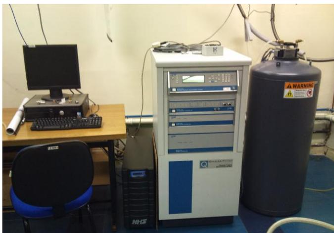
**Figura 4.10:** Equipamento PPMS pertencente ao Laboratório de Supercondutividade e Magnetismo do Instituto de Física da UFRGS.
