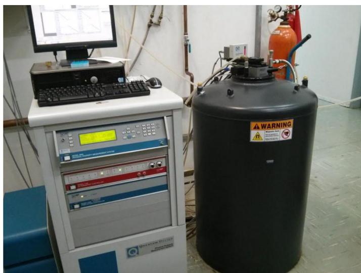
**Figura 4.11:** Equipamento PPMS-14 T pertencente ao Laboratório Temático do Instituto de Física 'Gleb Wataghin' da UNICAMP.
