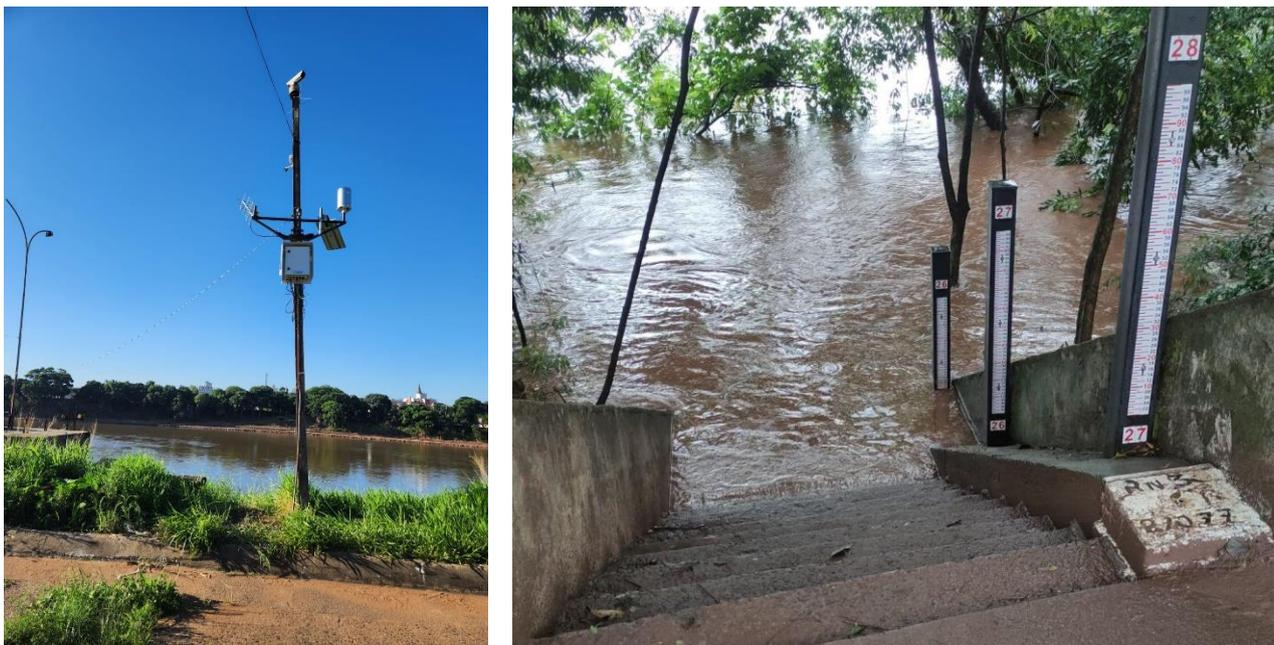
**Figura 9:** Posto fluviométrico 86879300, com sensor de telemetria automática, localizado no Porto Fluvial de Estrela (A) e réguas linimétricas localizadas na escadaria entre as ruas Osvaldo Aranha e João Abott, na cidade de Lajeado (B).
